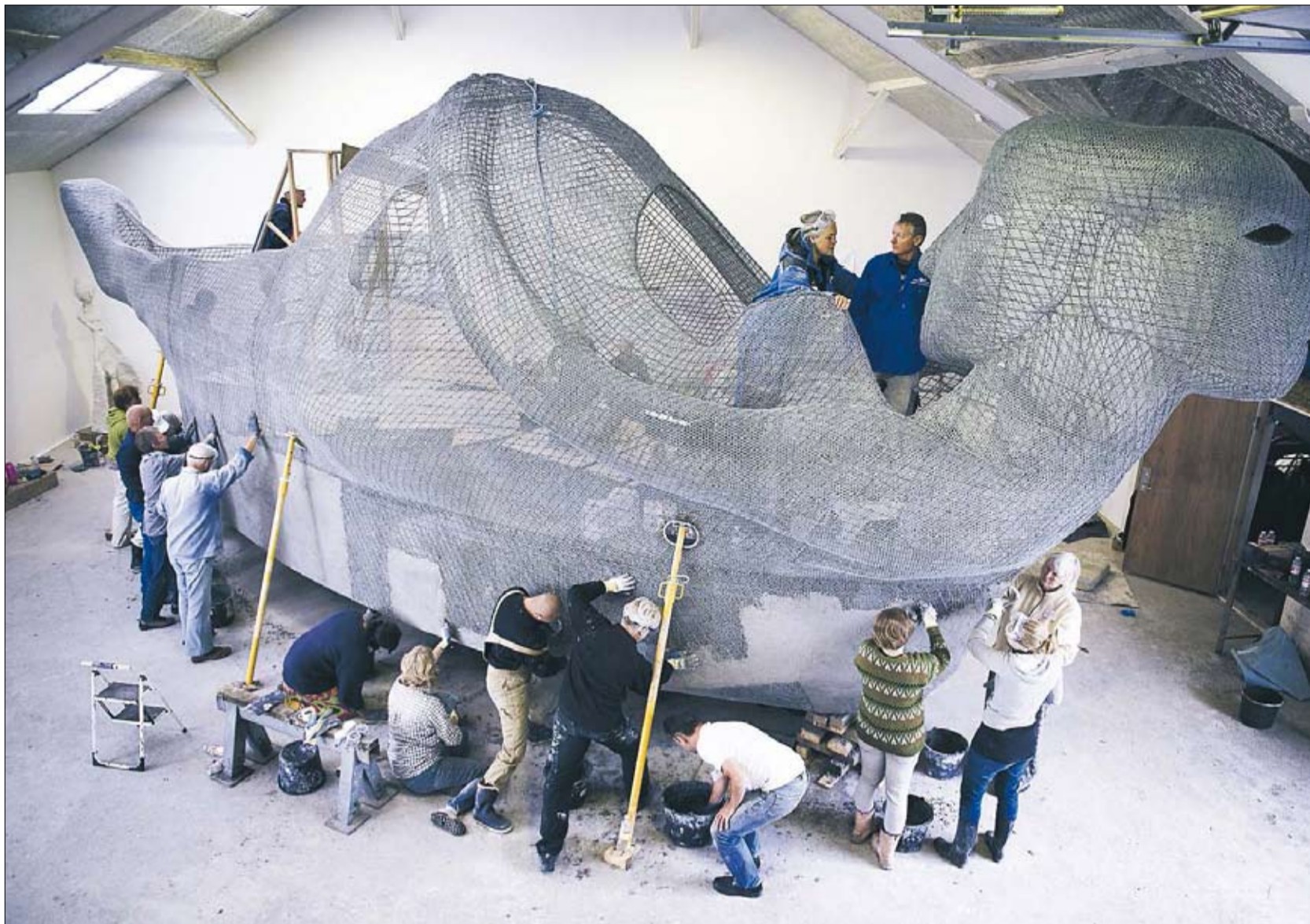
Båden påføres specialblandet beton med højt cementtal. Støbningen foregår ved, at der står personer inde i båden og presser beton igennem til dem, der står udenfor, som så presser tilbage i et samspil. Skelettet består af kyllingenet. Omkring 100 frivillige hjalp til med støbning, madlavning og meget andet i weekenden. Foto: Hans Ravn
